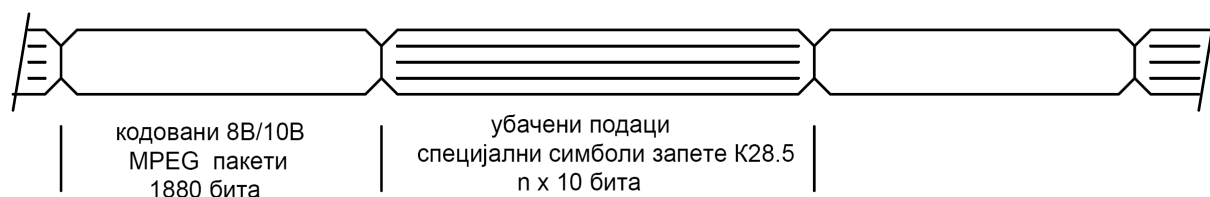
Слика Б.7 - Формат преноса са пакетима података (пример за 188-бајтне податке)
